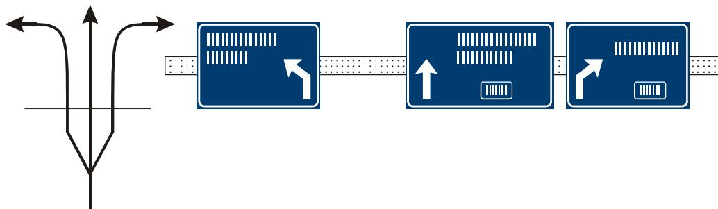
Značky č. IS 6g se užije v případě, že je umístěna nad začátkem nebo v průběhu rozšíření pro příslušný řadicí pruh (obr. )
