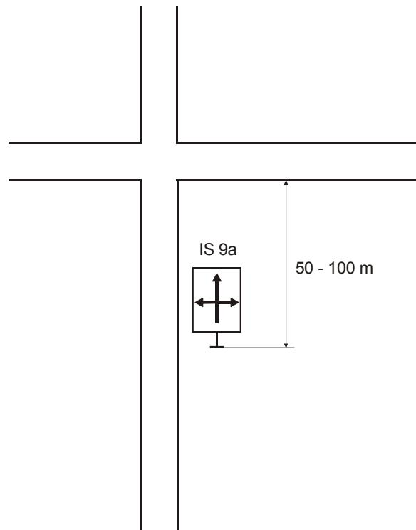
V případě, že je návěst umístěna dále než 100 m od hranice křižovatky, doplňuje se údajem o skutečné vzdálenosti se zaokrouhlením na desítky metrů (obr. ).
