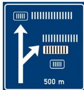
Značka se umísťuje ve vzdálenosti 50-100 m před hranicí křížovatky, výjimečně může být tato vzdálenost kratší; i v takovém případě však musí být značka umístěna před začátkem úseku určeného pro řazení vozidel před křížovatkou. Pokud je to v konkrétním případě pro orientaci významné nebo pokud je nutno značku přesněji orientovat k dané křížovatce, lze ve spodní části značky uvést vzdálenost v metrech k hranici křížovatky.
