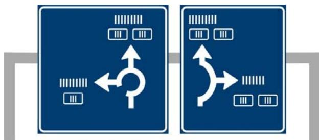
V případě zákazu nebo omezení platných pro výjezdovou větev křižovatky se na značce č. IS 9b vyznačuje symbol příslušné značky (obr.).
