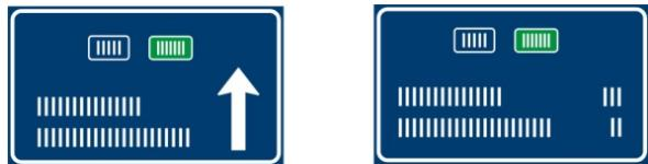
Značka informuje o cíli, čísle silnice a směru (č. IS 8a) nebo vzdálenosti k uvedeným cílům v km. Značky č. IS 8a se užívá zejména k potvrzení směru v rámci rozlehlé nebo složité křižovatky. Značky č. IS 8b se užívá zejména mimo křižovatku (např. při výjezdu z města).
