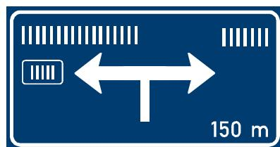
Pokud je před křižovatkou užito dopravní značky (značek) označující řadicí pruhy, vztahují se údaje o vzdálenosti platné pro umístění dopravních značek ODZ od hranice křižovatky k místu osazení dopravní značky (značek) pro řazení.
