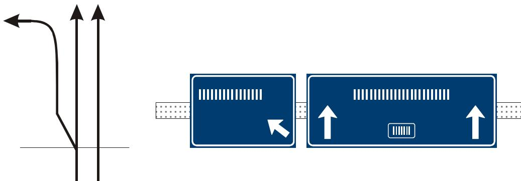
Vzhledem k tomu, že sestava uvedených návěstí umístěných nad vozovkou stanoví způsob řazení do řadicích pruhů, musí být značkou označen každý řadicí pruh. Pokud pro daný směr není k dispozici žádný vhodný cíl, obsahuje značka nad takovým pruhem pouze šípku (obr. ...).
