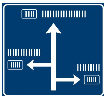
V případě, že se ve vzdálenosti do 100 m nachází jiná dopravně málo významná křížovatka (bez potřeby uvádět cíl), vyjadřuje se tato situace schematicky čárou bez šipky (obr.).
