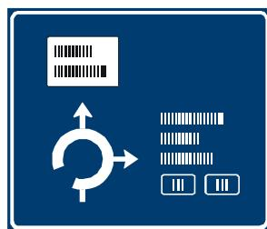
Odpovídající grafické provedení značky má význam zejména v případě návěsti před okružní křižovatkou s odlehčovací větví křižovatky („bypassem“) nebo před okružní křižovatkou se spirálovitým uspořádáním jízdních pruhů na okružním pásu křižovatky (spirálovitá křižovatka) - obr.
