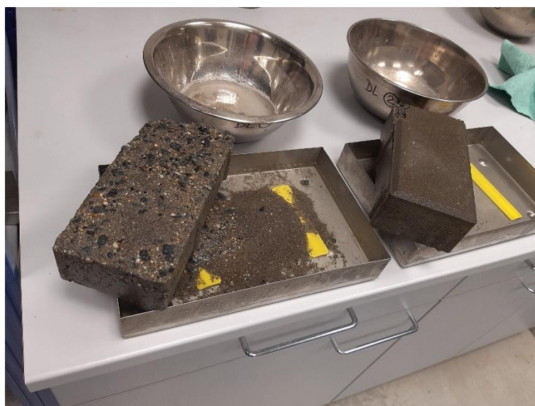
Obr. 3: Vizuální porovnání účinnosti sekundární ochrany betonové dlažby ošetřené prostředkem Emulze LO (vpravo) s referenčním betonem (vlevo) po zkoušce „odolnosti betonu“ (50 zmrazovacích cyklů), zdroj: CDV
