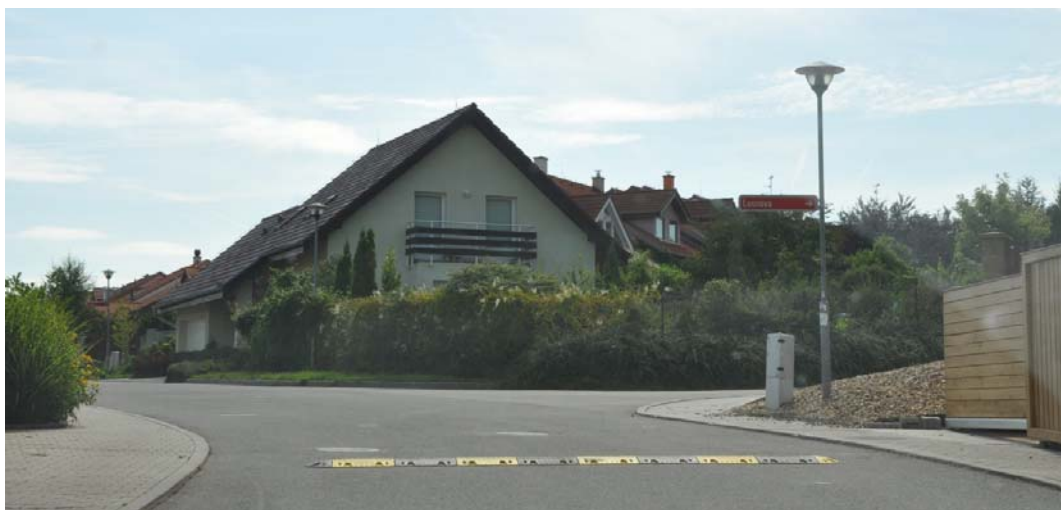
Obrázek 5 - Příklad umístění krátkého zpomalovacího prahu
