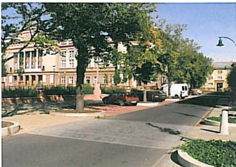
Obr. 12 Zpomalovací práh použitý jako místo pro přecházení
