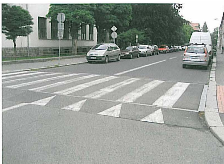
Obr. 7 Vyznačení vodorovné dopravní značky č. V 17 na pozemní komunikaci
